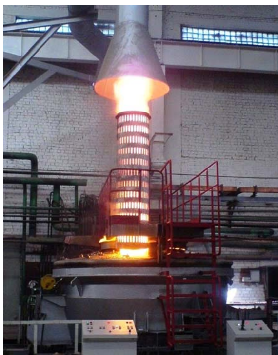
Рис 4. Плавка металлов в ДППТУ-НП с организованным дожиганием отходящих газов при плавке сильно загрязненной шихты (Рис. 5.)
