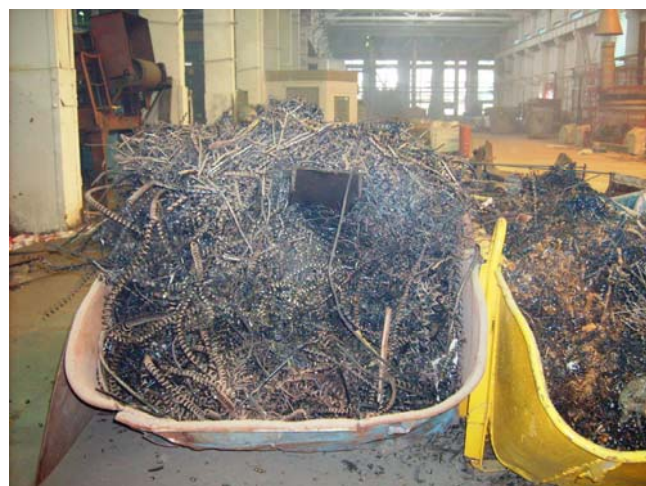
Рис. 5. Пример переплавляемой шихты (стружка с высоким содержанием СОЖ и масел).
