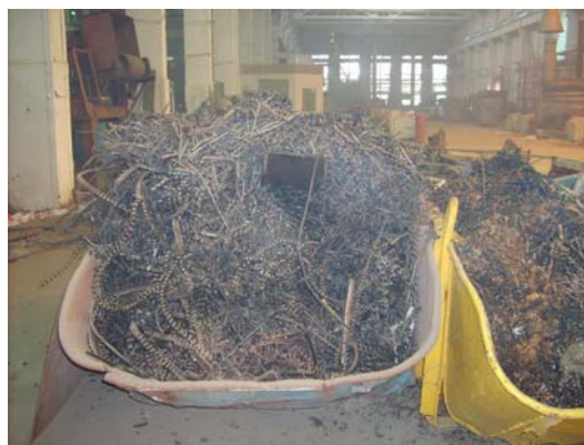
Рис. 3. Пример переплавляемой шихты в ДППТУ-НП (стружка с высоким содержанием СОЖ и масел).
